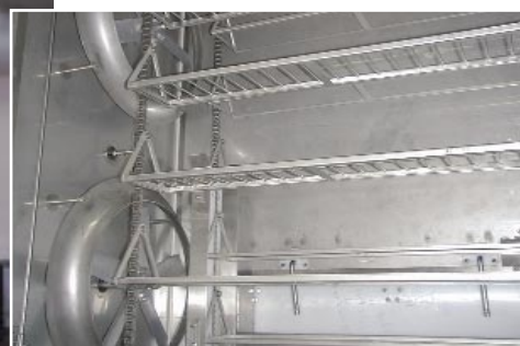
Abb. 9: Kompakter Vertikalfroster zum Krustenfrosten vor dem Schneiden z.B. von Schinken
