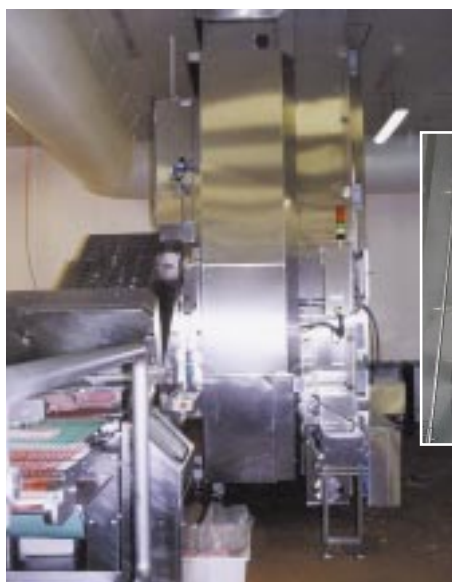
Abb. 9: Kompakter Vertikalfroster zum Krustenfrosten vor dem Schneiden z.B. von Schinken
