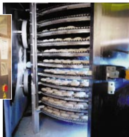
Abb. 7: Durch seine Modulbauweise ist der Cryogen®-Rapid-Langtunnel jederzeit erweiterungsfähig
