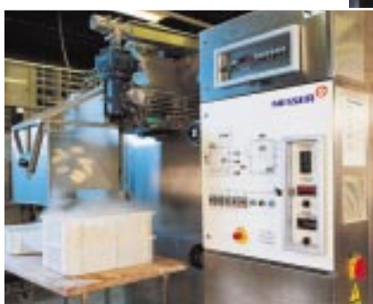
Abb. 8: Der Wendelbandfroster bietet eine hohe Gefrierleistung auf wenigen Quadratmetern Grundfläche
