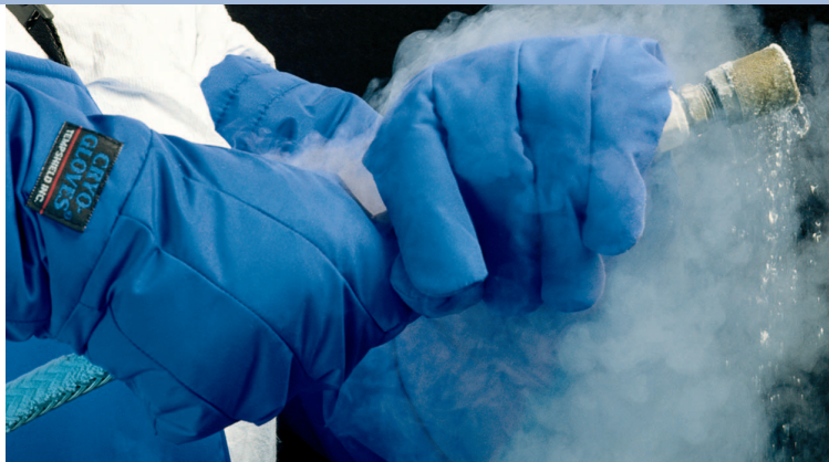
Bild 1: Das Außenmaterial dieser Handschuhe aus semipermeablem Nylon ist wasserabweisend und gleichzeitig atmungsaktiv. So kann es nicht durchfeuchten und kälteleitend werden.
