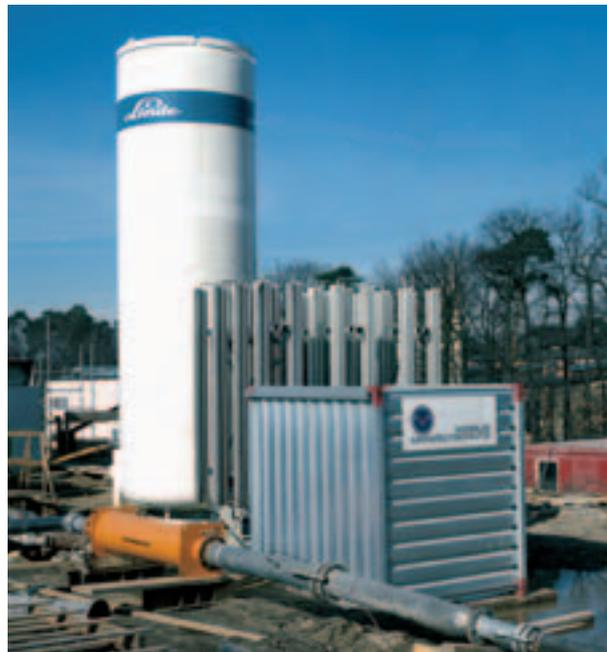
Neutralisation von Abwässern beim Bau der Autobahn am Frankfurter Kreuz (NEUSED-Anlage als Komplettlösung mit Bediencontainer [r.] und Kohlendioxidtank)
