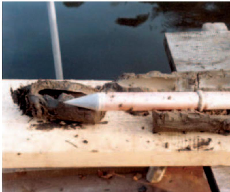
Die angefrorenen Sedimente können leicht abgeschlagen werden, und die Sonde ist wieder einsatzbereit.
