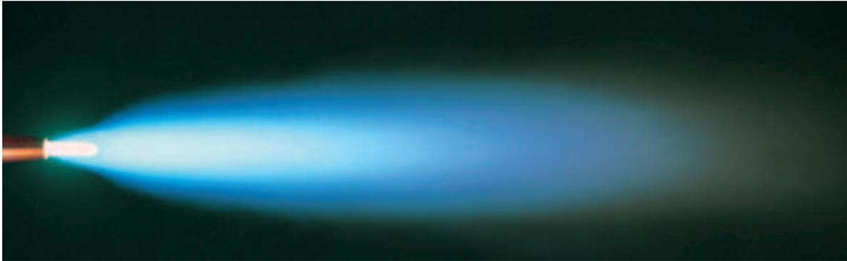
Die Autogenflamme, hier Acetylen/Sauerstoff, ist durch einen scharf abgegrenzten Flammenkegel gekennzeichnet.
