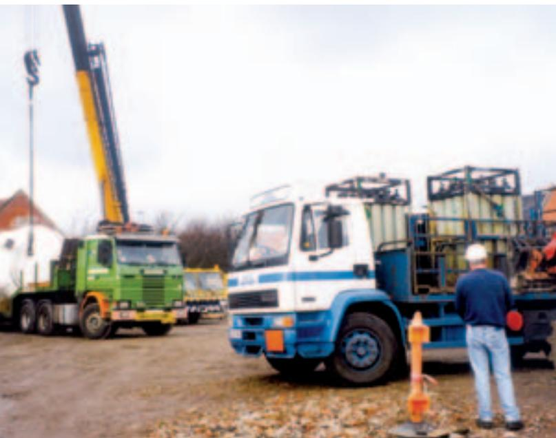
Baustellenversorgung mit Flüssig-Stickstoff-Tank und Flaschenbündel
