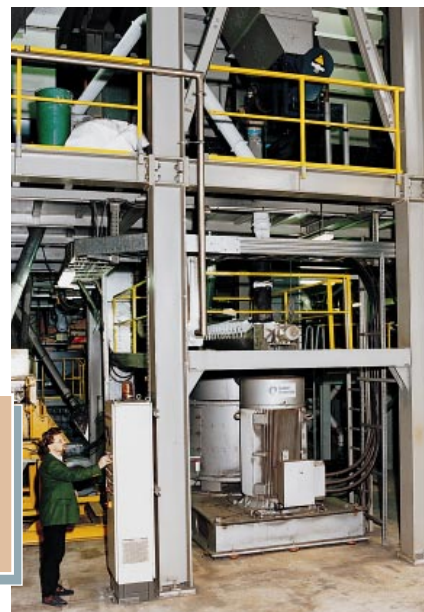
Abb. 4: Ultra-Rotor-Mühle VI, Jäckering GmbH, mit einer Antriebsleistung von 400kW/h und einer Mahlleistung von ca. 500 bis 750 kg/h (95.30.76.a-8)
