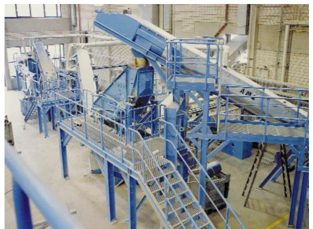
Abb. 3: Mit einer modernen Recyclinganlage entsorgt RWE Umwelt West rund 300.000 Kühlgeräte pro Jahr (Foto: RWE Umwelt West)
